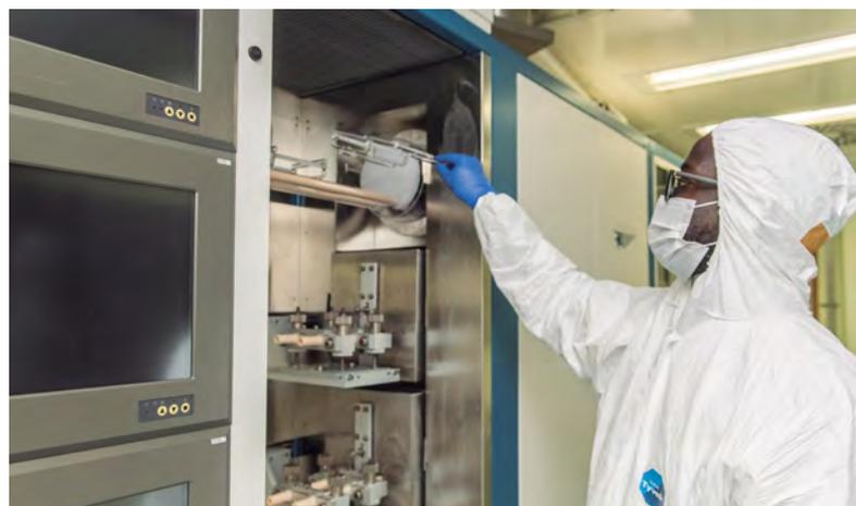
Lâminas texturadas, é hora de migrar ao laboratório de difusão, onde os materiais são colocados em fornos e submetidos à temperatura de 850 graus Celsius. Se antes impurezas indesejadas eram neutralizadas, agora outras específicas (fósforo, boro ou alumínio), os dopantes, são introduzidas para alterar a condutividade da célula solar.
